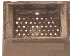
Brudny rusz paleniskowy z otworami zapchanymi popiołem
