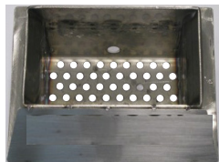
Czysty rusz paleniskowy, wszystkie otwory są widoczne
